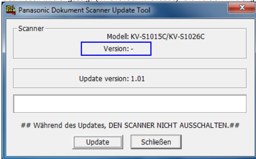
\* Wenn das Firmware Update der KV-S1015C fehlschlägt, wird der Scanner als KV-S1026C erkannt. Das Update wiederholen. Der Scanner wird wieder als KV-S1015C erkannt wenn das Firmware Update erfolgreich war.
