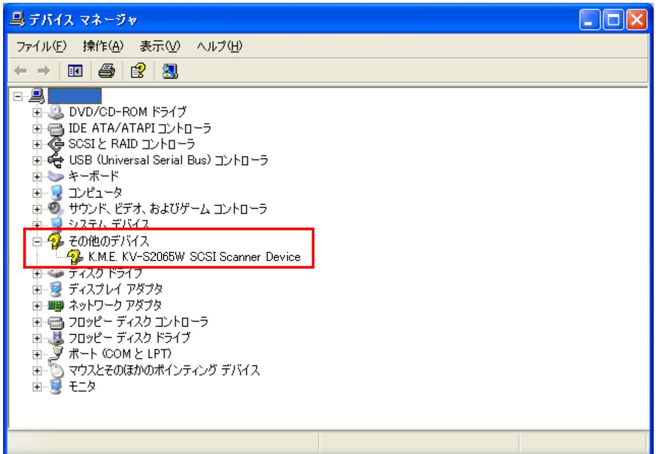
上図のように、「その他のデバイス」に「K.M.E. KV-S2065W」などのスキャナ名が表示されれば正常です。
